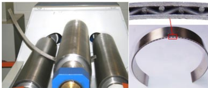
Biegung des Gitterblechs in der Rundbiegemaschine
